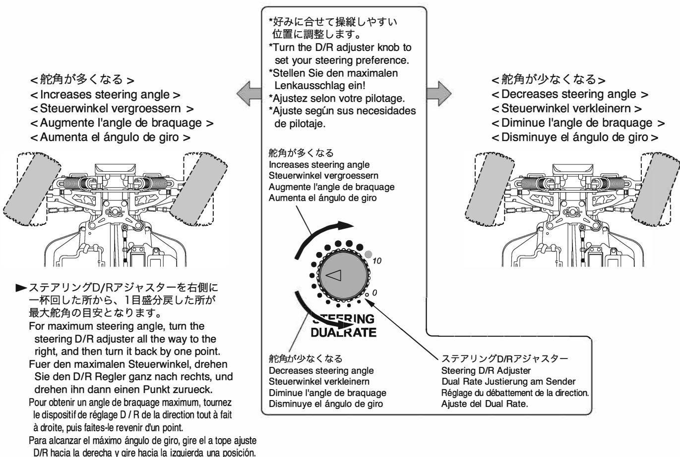
►ステアリングD/Rアジャスターを右側に一杯回した所から、1目盛分戻した所が最大舵角の目安となります。
