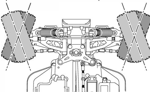
\* ステアリングホイールの操作量に応じて舵角が変わります。操作量が大きいほど、舵角も大きくなります。
