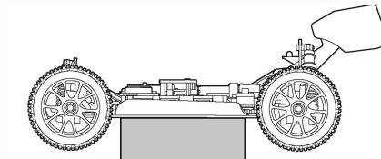
**③ 動作確認の際、タイヤが接触しないように台の上に乗せて浮かせます。**
