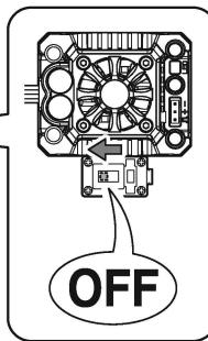
►走行後や、走行させない時は必ず電源スイッチをOFFにし、車体と送信機の電池を取り外してください。誤作動や電池の発熱・液漏れなど危険な場合があります。
