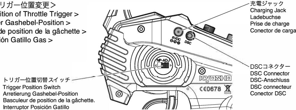
送信機裏面のスイッチを移動させることで、スロットルトリガーの作動範囲を7:3、5:5の2種類選択できます。
