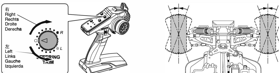
►ステアリングホイールに指を触れない(ニュートラル)ときタイヤがまっすぐになるようにステアリングトリムで微調整します。
