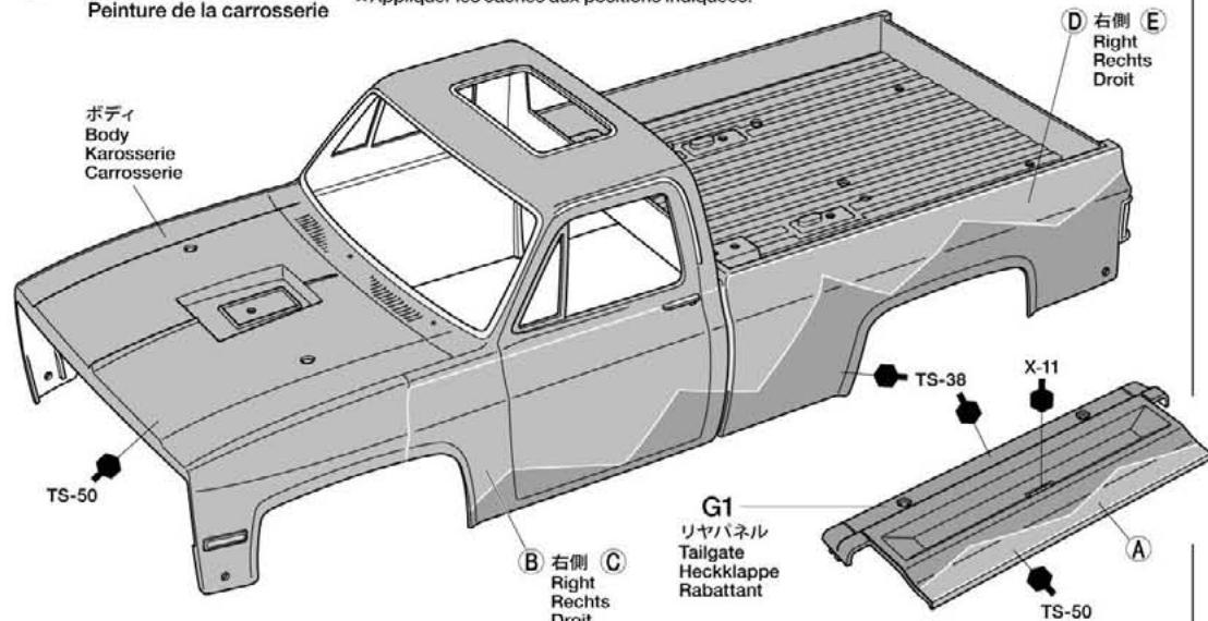
★ボディ全体をマイカブルーで塗装します。完全に塗装を乾かしてから、マスキングラインシールを貼り、別売のマスキングテープやビニール袋を利用してマイカブルーに残す部分をマスキングします。
